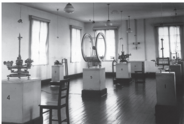
图9 北京地磁台绝对观测室内安装有马丁、舒米特、阿斯卡尼亚、质子分量仪等地磁观测仪器
