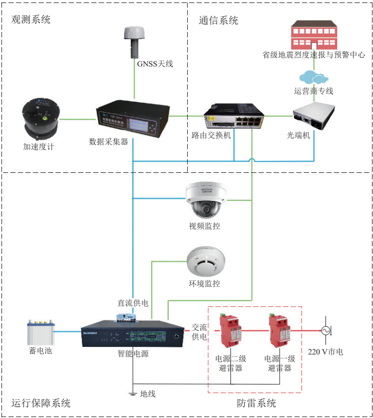
图 4 江西台网地震预警基本台站技术系统设备构成图
