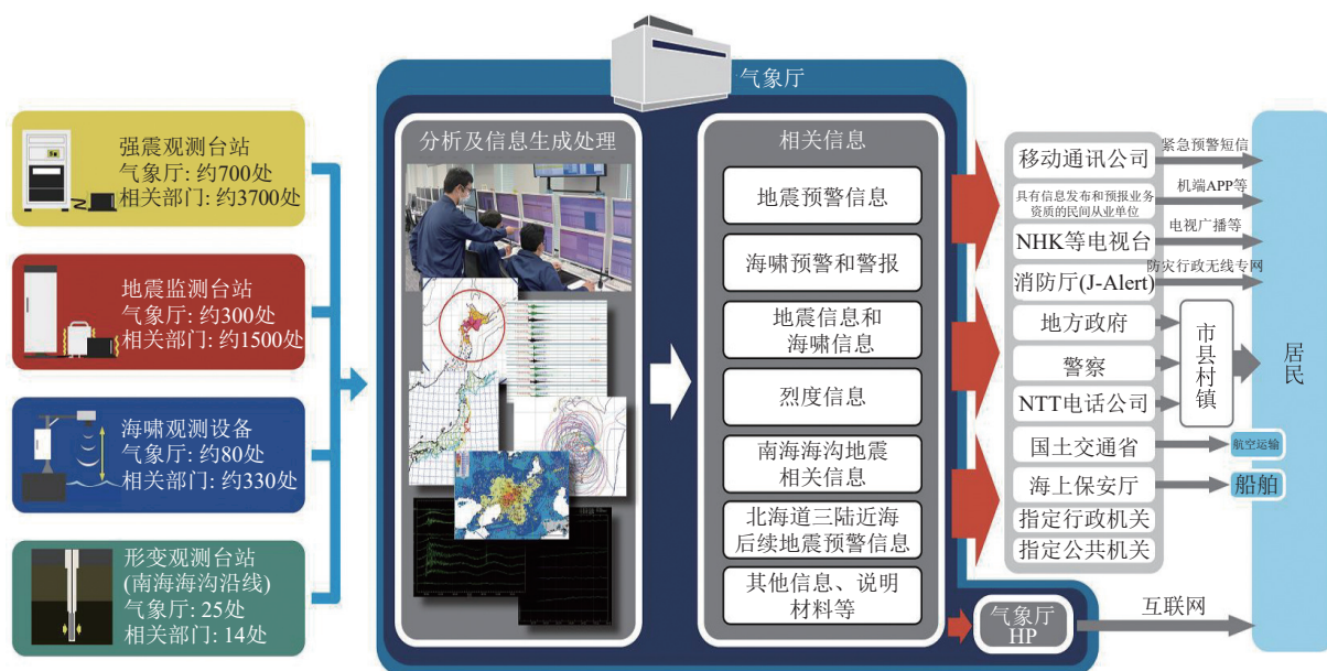
图2 日本气象厅地震海啸观测系统架构图 [2]
